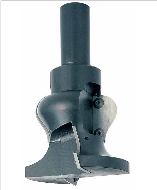
Abb. 7: Qualitätsmerkmal großdimensionierte Spanräume: Brustverschraubung mit hochfesten Spezialschrauben beim Handlaufräser Z2 + 2 HW
