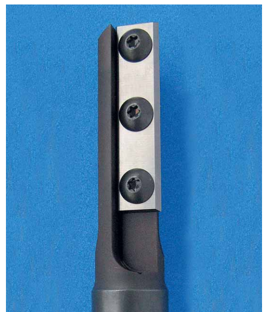
Abb. 8: Qualitätsmerkmal Sicherheit: Großdimensionierte Spezialschrauben für die Rückenverschraubung der Wendepatte
