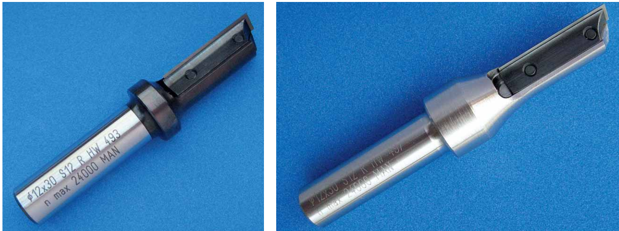
Abb. 2 a) links: Werkzeug aus CrNiMo-Stahl, b) rechts: Tragkörper aus Schwermetall: Gleiche Nutzlänge und gleicher Nenndurchmesser, Werkzeug rechts 2,7-fach schwerer
