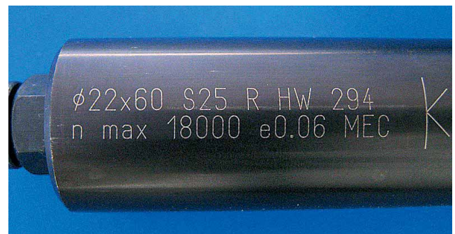
Abb. 5: Qualitätsmerkmal Sicherheit: Kennzeichnung des Werkzeugschaftes nach EN 847, Herstellerzeichen auf der Rückseite
