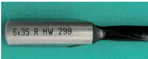
Beschriftung mit Durchmesser, Bohrtiefe, Drehrichtung und Schneidstoffgruppe
