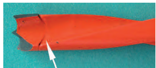
Sichtbare Vertiefungen an der Lötstelle
