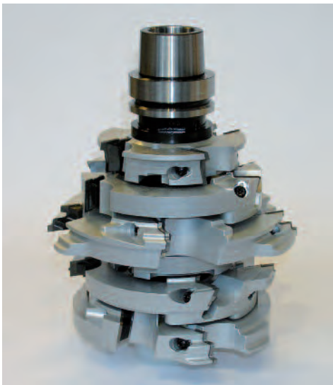
CNC-Werkzeugsatz mit Leichtmetall-Tragkörper
