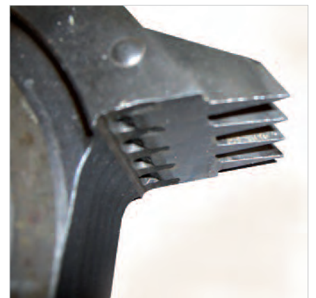
Stumpfe Minizinkenfräser mit Verschleißfase
