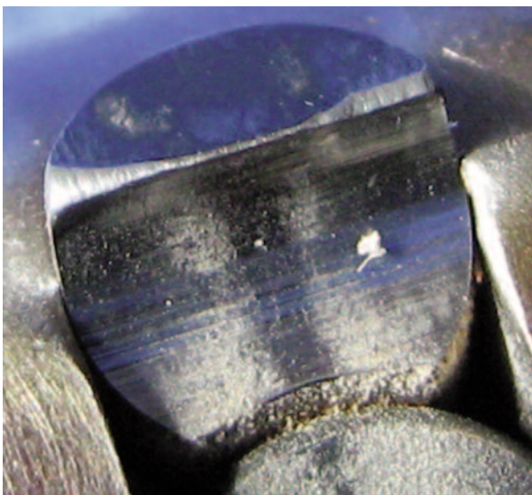
Abb. 7: Verschleißform am Frässtift in der Türenmittelebene
