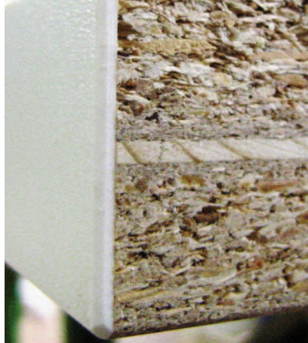
Abb. 8: Schichtaufbau eines Türelementes für modulare Raumtrennsysteme
